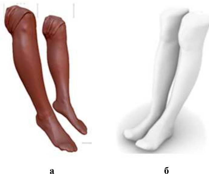
Рисунок 1. Цифровые модели ног, полученные в результате сканирования портативными 3D сканерами: а - Artec 3D Eva, б - Kinect
